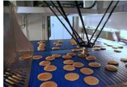
Robot delta flexpicker utilisé dans l'industrie agroalimentaire afin de répondre à des exigences de vitesse et précision importante.
