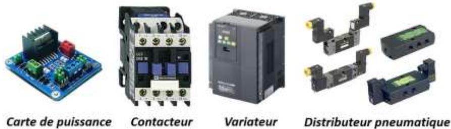
Certains pré-actionneurs tels que les **relais, contacteur, distributeur** sont dits « **tout ou rien** ». Ils jouent le rôle d'interrupteur de la chaîne d'énergie-puissance. Les autres pré-actionneurs tels que les **variateur, hacheur, carte de puissance** laissent passer seulement une partie de la puissance disponible. Ils **modulent** (régulent) la puissance **délivrée**.
