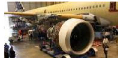
Pour le motoriste Pratt & Whitney : le système étudié est le moteur (ce qui correspond à un sous-système pour Dassault). Son environnement comprend l'air et le reste de l'avion. Nacelle et fuselage deviennent des éléments de l'environnement extérieur. Les constituants internes comprennent le rotor, le stator, les différents capteurs (qui peuvent eux aussi être perçu comme un système...) ...
