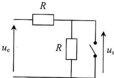
Pont diviseur de tension :  $u_s = \frac{R_0}{R + R_0} u_e$ .
