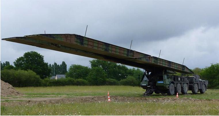
Le Système de Pose Rapide de Travures (SPRAT) est un improbable véhicule assurant la dépose rapide d'un pont mobile permettant de franchir une brèche ou rivière de 25 m de large en moins de 10 min. Avant dépose, 2 travures (constituant le pont) sont déployées et assemblées sur une poutre de lancement.
