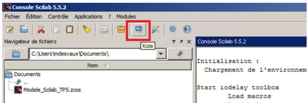
Le module Xcos permet de simuler l'évolution de différentes fonctions mises sous forme de fonctions de transfert à l'aide de la transformée de Laplace. Lorsque vous lancez Xcos, deux pages s'ouvrent : une page de navigation qui permettra de choisir les différents blocs à intégrer dans notre étude et une page dans laquelle vous réaliserez votre étude. Parmi les différents dossiers présents dans la page de navigation, nous utiliserons uniquement le dossier « CPGE ».
