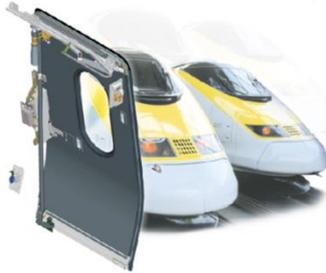
Afin d'assurer la sécurité des usagers des trains à grande vitesse (TGV), un système d'ouverture des portes permettant d'entrer et de sortir a été mis en place. Différents éléments composent ce système pluri-technologique. La figure ci-dessous montre l'interface assurant, à partir des informations délivrées par l'unité centrale de commande, la fermeture hermétique et le verrouillage d'une porte.
