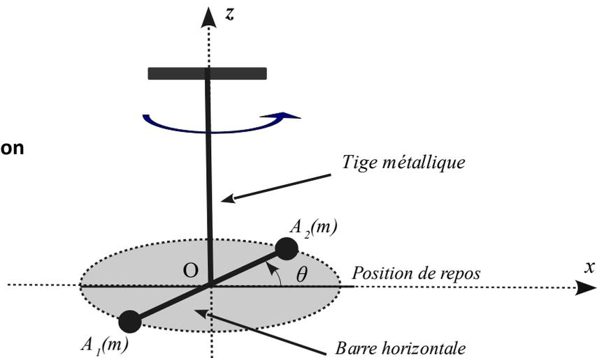
On note  $J=2md^2$  le moment d'inertie par rapport à l'axe  $Oz$  du système  $S$  constitué par la barre horizontale et les deux masses  $m$ .
