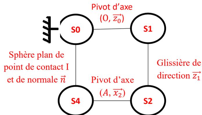
**Question 2.** Réaliser un schéma cinématique 2D dans le plan  $(O, \vec{x}_1, \vec{z}_1)$
