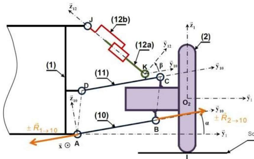
On isole 2, la pièce est soumise à 3 actions mécaniques :
