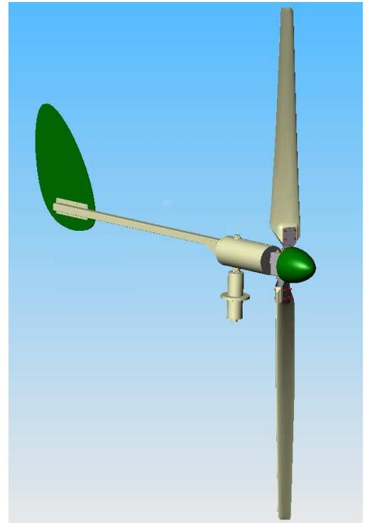
Soit  $R_0(O, \vec{x}_0, \vec{y}_0, \vec{z}_0)$  un repère lié au support **0** d'une éolienne. La girouette **1** a une liaison pivot d'axe  $(O, \vec{z}_0)$  avec le support **0**.
