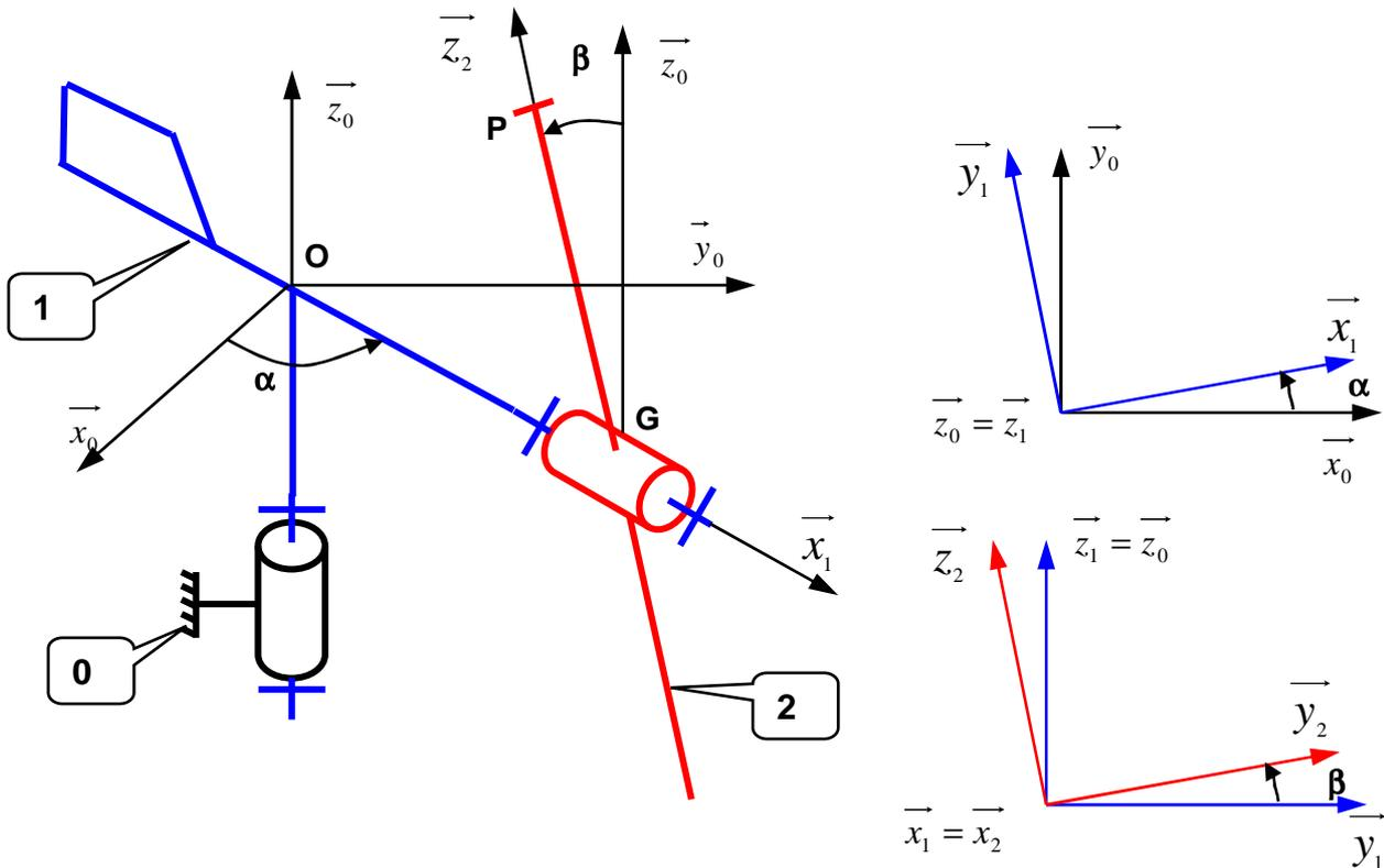
Soit  $R(O, \vec{x}_0, \vec{y}_0, \vec{z}_0)$  un repère lié au support **0** d'une éolienne. La girouette **1** a une liaison pivot d'axe  $(O, \vec{z})$  avec le support **0**.
