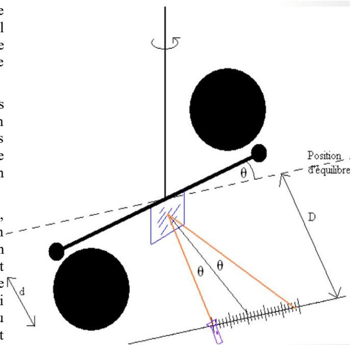
Une fois le pendule de Cavendish équilibré, il l'écarta très légèrement, et constata grâce au miroir et au faisceau lumineux qu'il oscillait autour de sa position d'équilibre avec une période d'oscillation  $T_0$  de 7 minutes (420 secondes). Une fois  $T_0$  connue, il pouvait calculer la constante de torsion C de son pendule.
