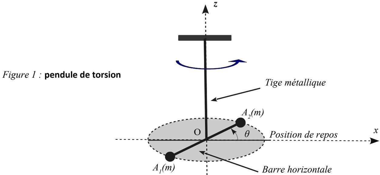
On note  $J = 2 m R^2$  le moment d'inertie du système  $S$  constitué par la barre horizontale et les deux masses  $m$  par rapport à l'axe  $Oz$ .
