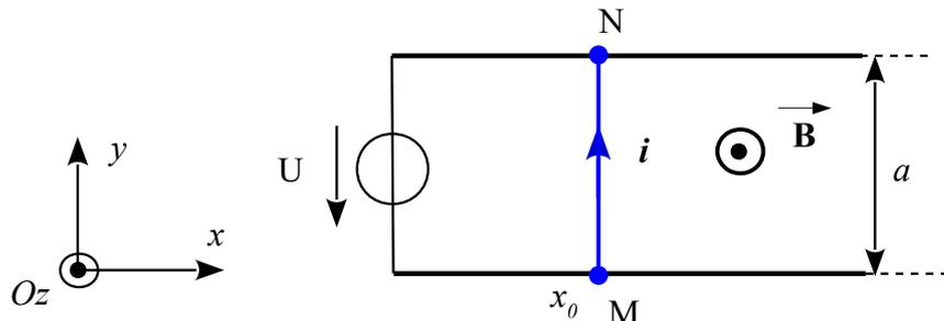
3. En ci-dessus, déterminer la force de Laplace s'exerçant sur la barre  $MN$  : vous appuyant sur le schéma
