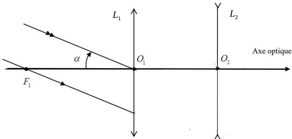
**Figure 3 :** Schéma optique de la lunette de Galilée
