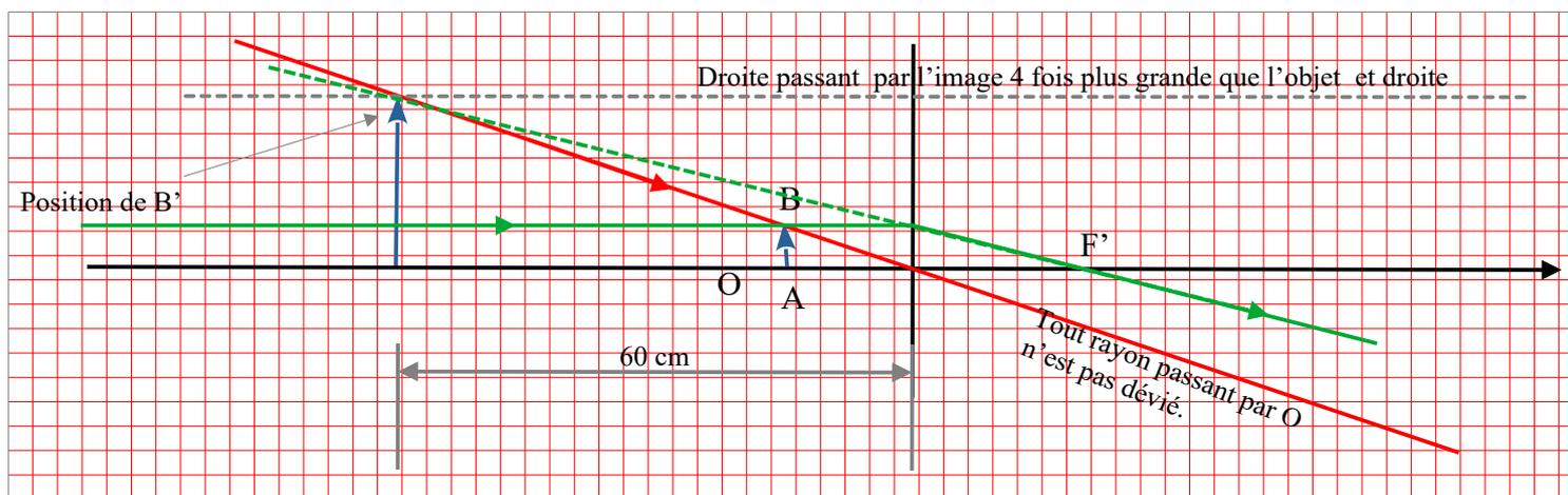
On trace dans un premier temps le rayon passant par O et B qui n'est pas dévié puis la droite en pointillés à une hauteur 4 fois plus grande que l'objet. On en déduit la position de l'image droite. Grâce à l'échelle, on en déduit qu'elle est 60 cm devant la lentille.
