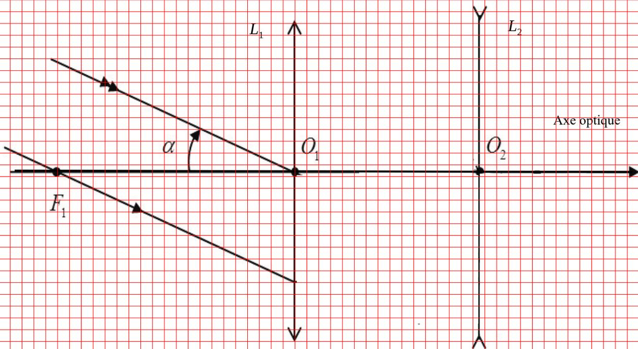
**Figure 3 :** Schéma optique de la lunette de Galilée
