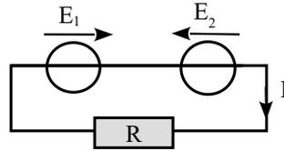
Deux générateurs de fem constantes  $E_1$  et  $E_2$  sont placés d'abord en série (cas 1), puis en opposition (cas 2) dans un circuit de résistance  $R$ .
