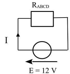
Les ampoules A et B consomment la même puissance :  $P_A = P_B = R I_{AB}^2 = 40 \times 0,06^2 = 0,144\ W$ .
