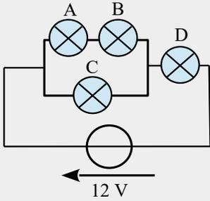
Quatre ampoules identiques A, B, C, D équivalentes d'un point de vue électrique à quatre résistances  $R=40\ \Omega$  sont connectées comme l'indique le schéma ci-contre.
