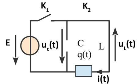
b) Pour  $t > 0$ , on applique la loi des mailles :  $u_c + u_R + u_L = 0$  or  $u_R = Ri$  et  $i = C \frac{du_c}{dt}$  et  $u_L = L \frac{di}{dt} = LC \frac{d^2 u_c}{dt^2}$
