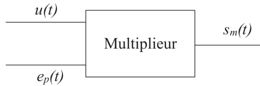
Figure 9 – Multiplication de l'onde porteuse et signal modulé
