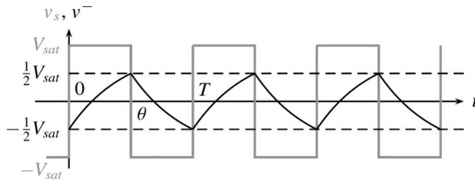
Sur  $[0, \theta]$ ,  $v_s(t) = +V_{sat}$  et  $v^-(t) = V_{sat} + \lambda \exp(-\frac{t}{\tau})$ . On choisit arbitrairement l'origine des temps lors d'une commutation vers le haut et donc, par lecture du cycle d'hystérésis :
