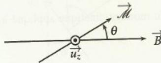
L'aimant est soumis à la réaction du support, qui s'exerce en  $O$ , donc de moment nul en  $O$ , au poids, de moment nul pour la même raison, et à la force magnétique de moment  $\vec{\Gamma} = \vec{M} \wedge \vec{B}$  :
