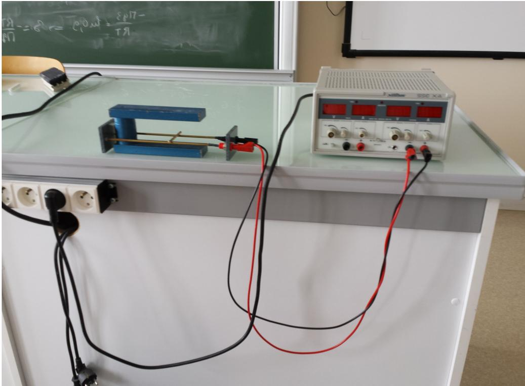
L'expérience du rail de Laplace est constituée de deux rails parallèles fixes alimentés par des conducteurs et une source continue. Le circuit est fermé par un rail mobile conducteur susceptible de rouler sur les deux rails parallèles. Le rail mobile est placé entre les branches d'un aimant en U. (voir figures ci-contre.)
