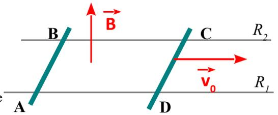
Ce dispositif est plongé dans un champ magnétique vertical, uniforme, d'intensité  $B$ .
