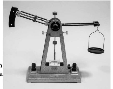
Elle est constituée de deux fléaux. L'un, à gauche, comprend sur sa périphérie, un conducteur métallique qui sera parcouru par un courant et dont une partie sera placée dans le champ magnétique, uniforme et permanent, à mesurer.
