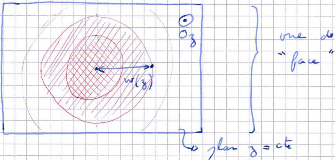
Conclu : le faisceau laser a un profil d'intensité de type gaussien. La grandeur  $w(z)$  représente en ODC la demie-largueur du faisceau à l'abscisse  $z$ ;  $w_0$  représente la demie-largueur minimale (le "vrais"), en  $z=0$ .
