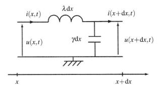
On suppose dx petit devant la distance caractéristique de variation de u(x,t) et i(x,t) de telle sorte que l'on puisse appliquer les lois des mailles et les lois des nœuds sur la portion de câble représentée sur la figure.
