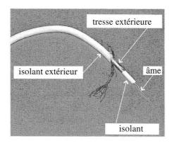
Si les conducteurs et l'isolant sont parfaits, il n'y aucune dissipation d'énergie. Un tronçon de câble compris entre les abscisses x et  $x+\mathrm{d}x$  peut alors être modélisé par le schéma de la figure suivante. Dans ce modèle, le câble possède une inductance  $\lambda\mathrm{d}x$  et une capacité  $\gamma\mathrm{d}x$ :  $\lambda$  et  $\gamma$  sont donc respectivement l'inductance linéique et la capacité linéique du câble.
