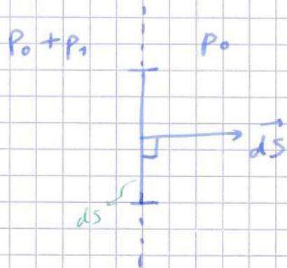
La résultante des forces de pression sur  $dS$  s'écrit  $d\vec{F} = (p_0 + p_1) \cdot d\vec{S} - p_0 \cdot d\vec{S} = p_1 \cdot d\vec{S}$  et la puissance associée :  $dP = d\vec{F} \cdot \vec{v}_1 = p_1 \cdot \vec{v}_1 \cdot d\vec{S}$
