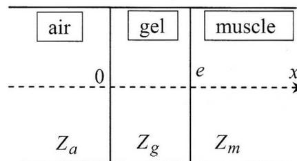
Ceci permet de réaliser une couche « anti-reflet » d'épaisseur  $e$  et d'impédance acoustique  $Z_g$ . On note respectivement  $c_a$ ,  $c_g$  et  $c_m$  les célérités du son dans l'air, le gel et le muscle et  $k_a = \omega/c_a$ ,  $k_g = \omega/c_g$  et  $k_m = \omega/c_m$  les nombres d'onde associés. On cherche, en notation complexe, des champs de vitesse sous la forme :
