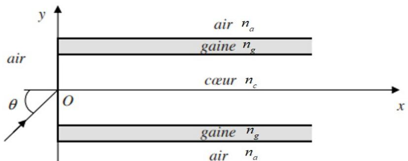
Un rayon lumineux monochromatique se propageant dans l'air d'indice  $n_a=1$ , situé dans le plan  $(Oxy)$ , pénètre dans le cœur de la fibre en  $O$  avec un angle d'incidence  $\theta$ .
