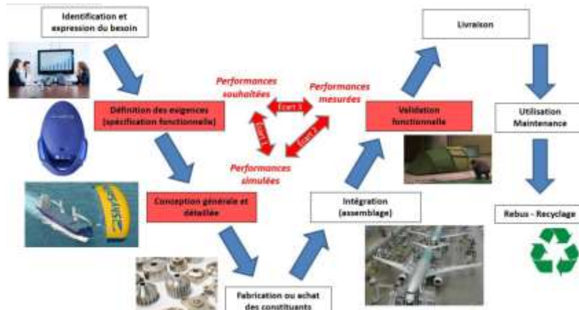
Figure 2 : Diagramme en V du cycle de vie
