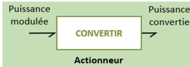
**Figure 14 :** schématisation de la fonction « Convertir »
