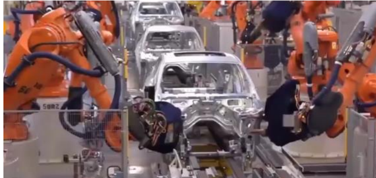
Figure 1 : Ligne de fabrication du véhicule X6 BMW
