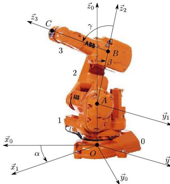
**Figure 5 :** Exemple de robot ABB
