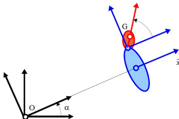
*Figure 2 : Modèle cinématique de la catapulte et d'un passager*
