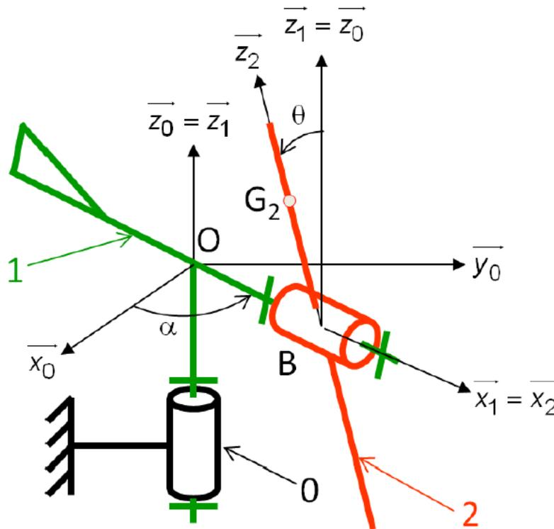
**Figure 7 :** Schéma cinématique de l'éolienne
