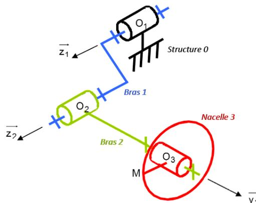
Avec  $\overrightarrow{O_1O_2} = a \vec{y}_1 + b \vec{z}_0$ ,  $\overrightarrow{O_2O_3} = c \vec{y}_2$  et  $\overrightarrow{O_3M} = R \vec{z}_3$
