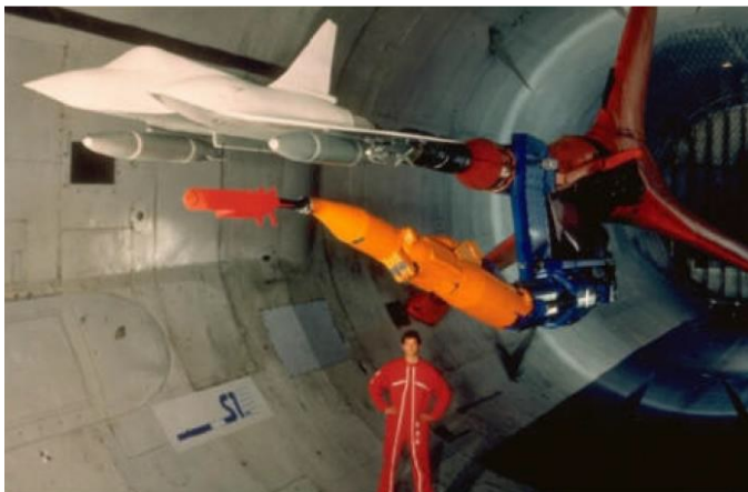
Photos 1 et 2 : Installation de trajectographie captive. Essai de largage d'un missile Exocet AM39 sous maquette de Rafale dans la grande soufflerie S2MA de l'ONERA à Modane.
