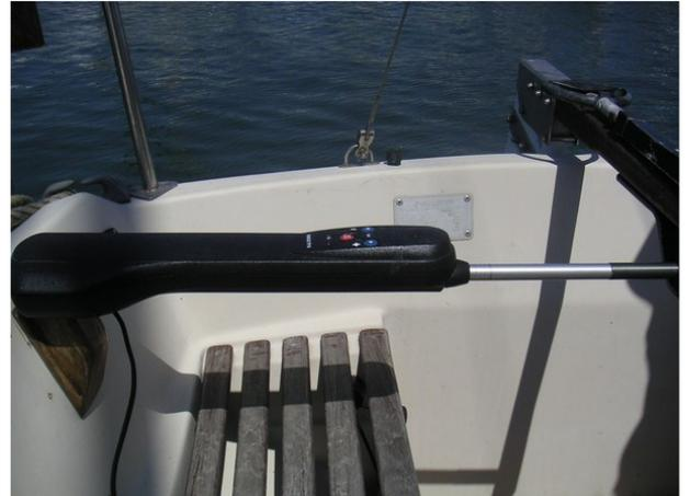
Lorsque le cap du bateau est bon, le compas du pilote est réglé sur le cap à suivre. Aucune information n'est alors transmise à l'électronique et le moteur n'est pas en mouvement. Si le bateau perd son cap, le compas du pilote s'en écarte d'autant et transmet un signal au moteur. La mise en rotation de ce dernier permet de translater l'écrou (solidaire de la barre) dans le sens adéquate ce qui permet finalement de ramener le bateau sur son cap.
