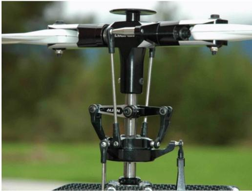
Un hélicoptère crée sa portance grâce au mouvement de rotation du rotor principal entraîné à l'aide de la turbine. Pour permettre à l'hélicoptère de se déplacer suivant les différentes directions, les pales prennent, suivant un axe radial, une incidence qui varie au cours de la rotation du rotor. Le dispositif qui transmet les consignes du pilote et qui permet d'imposer cette variation est le plateau cyclique dont l'orientation est fixée par l'intermédiaire de plusieurs vérins hydrauliques.
