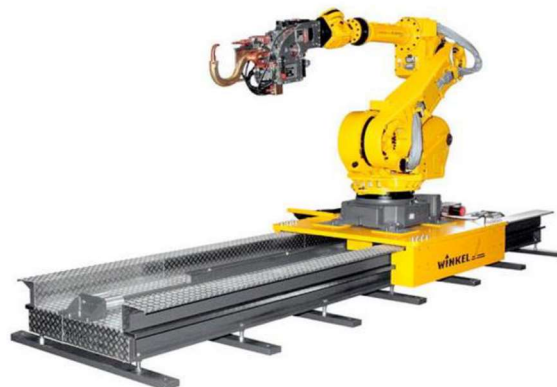
Figure 3 : exemple de robot avec positionnement linéaire
