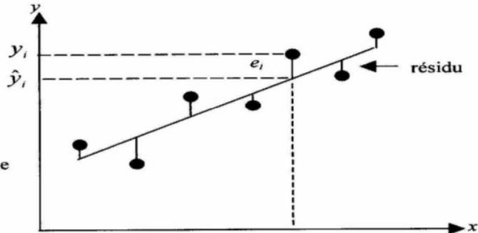
Etant donné un  $n$  échantillon de mesures physiques  $((x_i, y_i))_{1 \leq i \leq n}$ , on cherche à savoir si cet échantillon peut-être assimilé à des réalisations aléatoires de couples  $((x_i, ax_i + b))_{1 \leq i \leq n}$ , pour des paramètres  $a$  et  $b$  de régression linéaire, selon une relation linéaire de la forme
