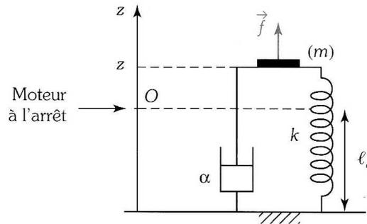
Quand le moteur fonctionne, tout se passe comme s'il apparaissait une force supplémentaire sinusoïdale  $\vec{f} = kA \cos(\omega t) \vec{u}_z$ ,  $A$  étant une constante positive. On pose :  $\omega_0 = \sqrt{\frac{k}{m}}$ , et  $\beta = \frac{\alpha}{\sqrt{mk}}$ .
