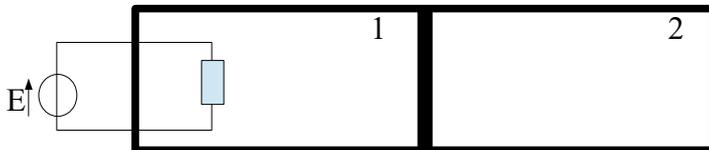
Grâce à une résistance électrique, on chauffe lentement le gaz 1 dans le compartiment de gauche jusqu'à la pression  $P = 2P_0$ .
