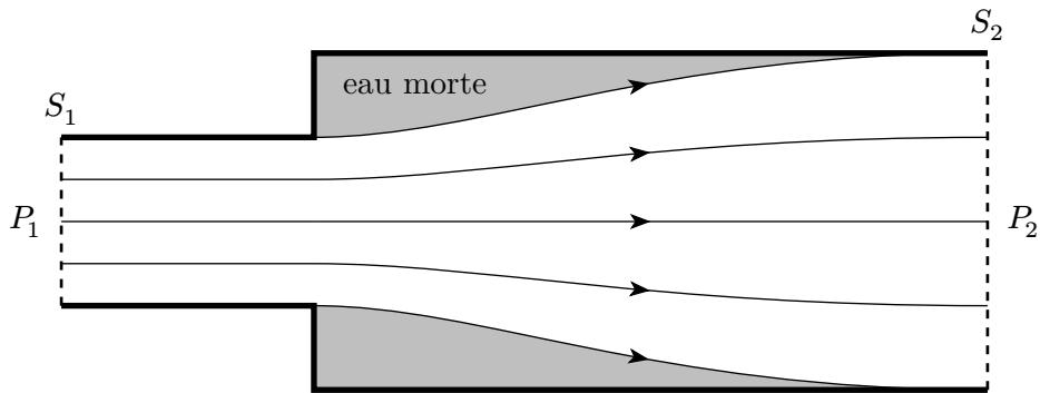
On suppose l'écoulement turbulent. Les lignes de courant représentées sont des courbes moyennes. Pour simplifier les calculs, on considère le champ de vitesse uniforme dans la section d'entrée  $S_1$ .
