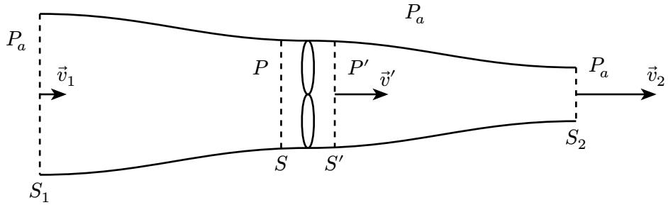
Sur la surface  $S_1$ , la vitesse est uniforme et égale à  $v_1 \vec{e}_x$ , sur  $S_2$ , elle vaut  $v_2 \vec{e}_x$ .
