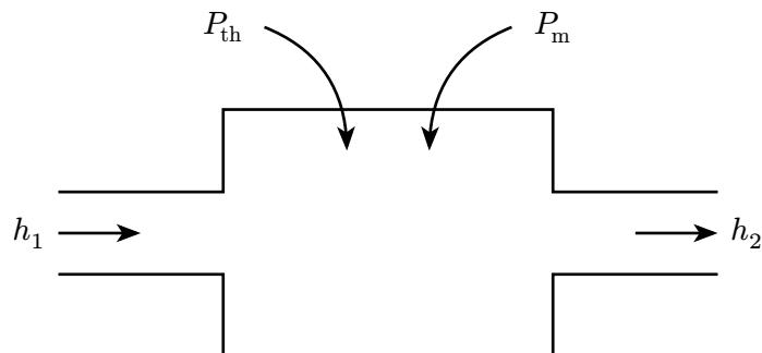
1/ À l'aide du premier principe de la thermodynamique, établir un lien entre ces deux puissances,  $D$  et les enthalpies massiques du fluide en entrée et en sortie.
