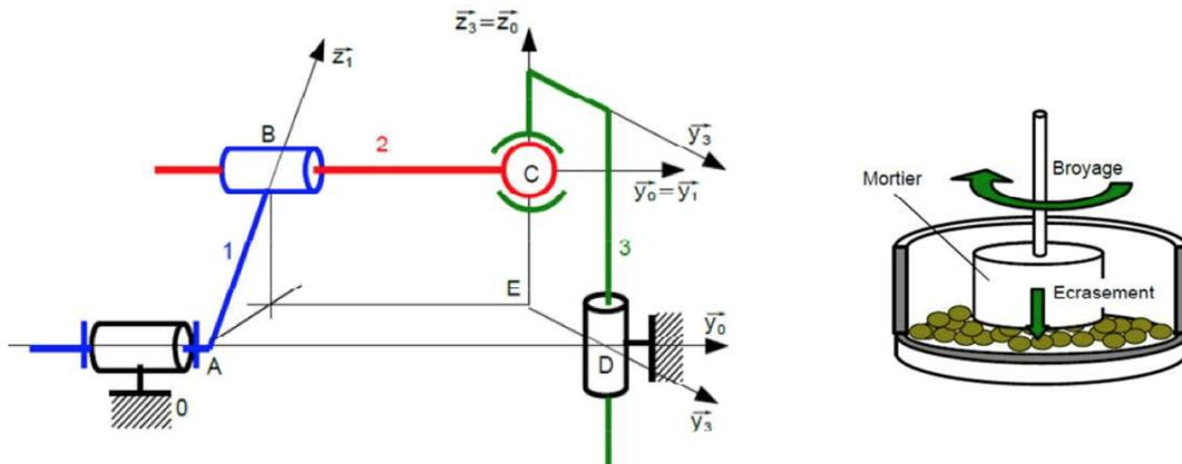
Données :  $\vec{AB} = R.\vec{z}_1$  ;  $\vec{BC} = \lambda(t).\vec{y}_1$  ;  $\vec{AD} = d.\vec{y}_1$  ;  $\vec{EC} = h(t).\vec{z}_0$  ;  $\vec{ED} = L.\vec{y}_3$
